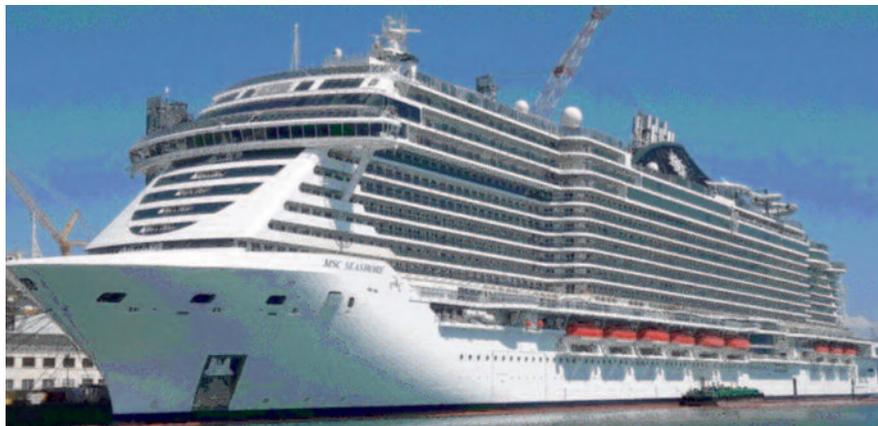
stemi ibridi di lavaggio dei gas di scarico (EGCS) e sistemi selettivi di riduzione catalitica (SCR), ottenendo una riduzione del 98% delle emissioni di ossido di zolfo
